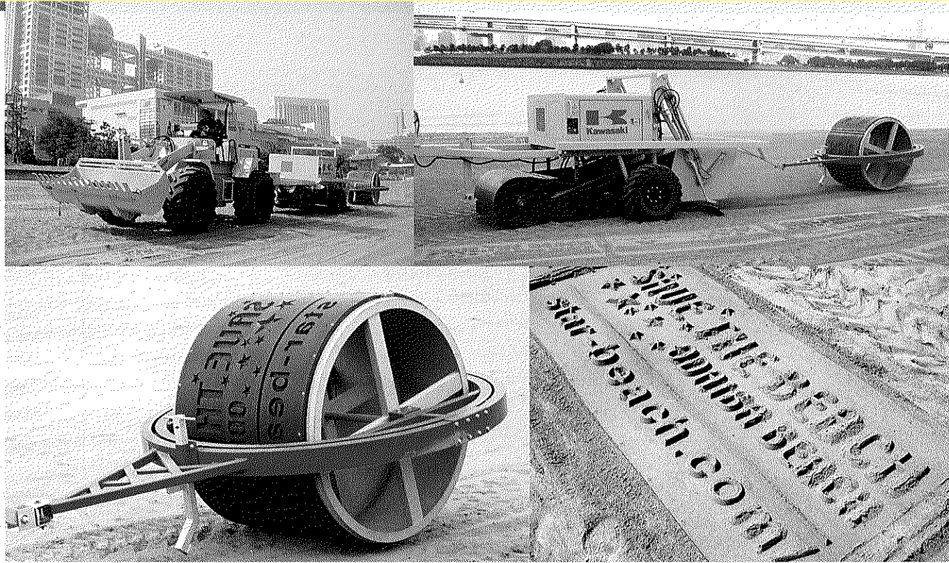
▲左上・砂浜を掃除する清掃車/右上・ゴミを収集するパーツとスタンプ部分の連結/左下・スタンプロール。清掃車に引っ張られてスタンプをする/右下・文字がくっきりとみえるようにスタンプされている
